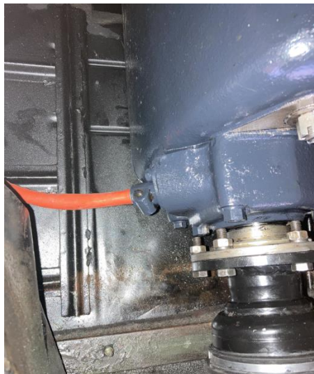
Neue Tachowelle am Getriebe angeschlossen.
