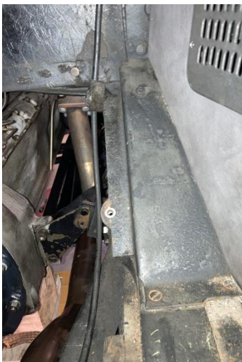
Tachowelle vom Getriebe zum Tacho war defekt; wurde mit neuer Welle der Firma Autometer ersetzt.
