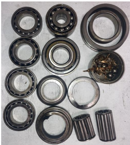
Sämtliche Lager im Getriebe ersetzt
