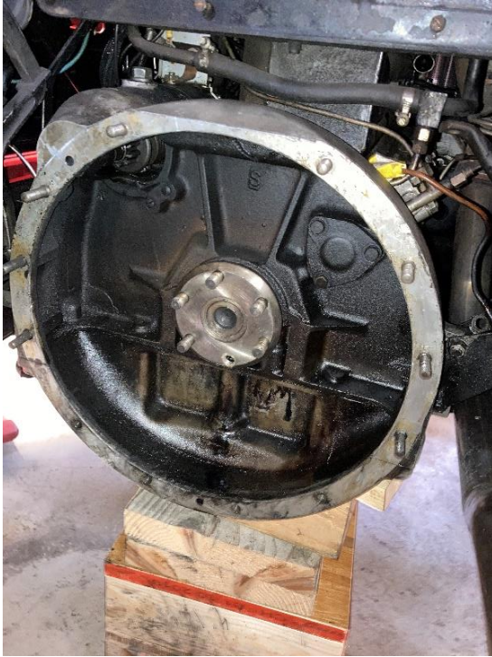
Getriebe, Kupplung und Schwungrad demontiert, Blick auf Kurbelwelle und Motorblock
