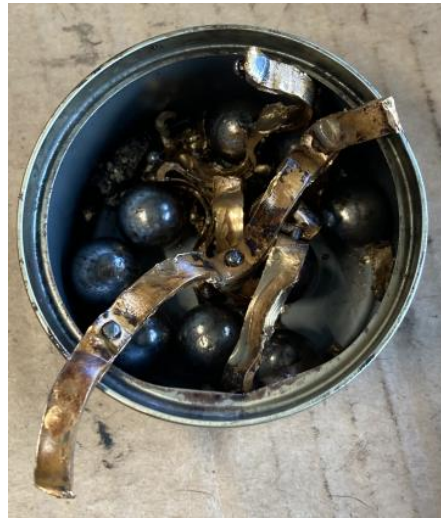
Befund: die 90-jährigen Lager sind defekt. Zum Glück ist nichts Schlimmeres passiert
