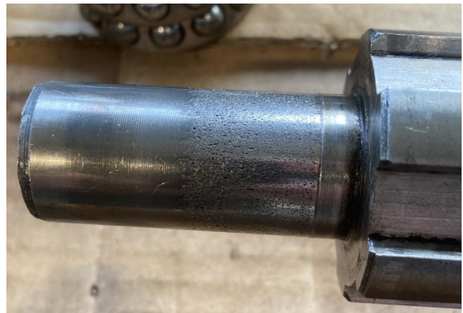
Wellen im Getriebe teilweise angefressen, wurde mit einer Occasionwelle ersetzt
