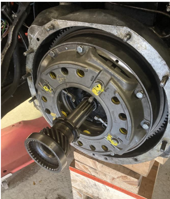
Kupplung nach Revision montiert, Kupplungsscheibe zentriert
