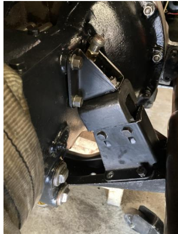
Auch die Silentblöcke in den Getriebe-Halterungen sind neu.
