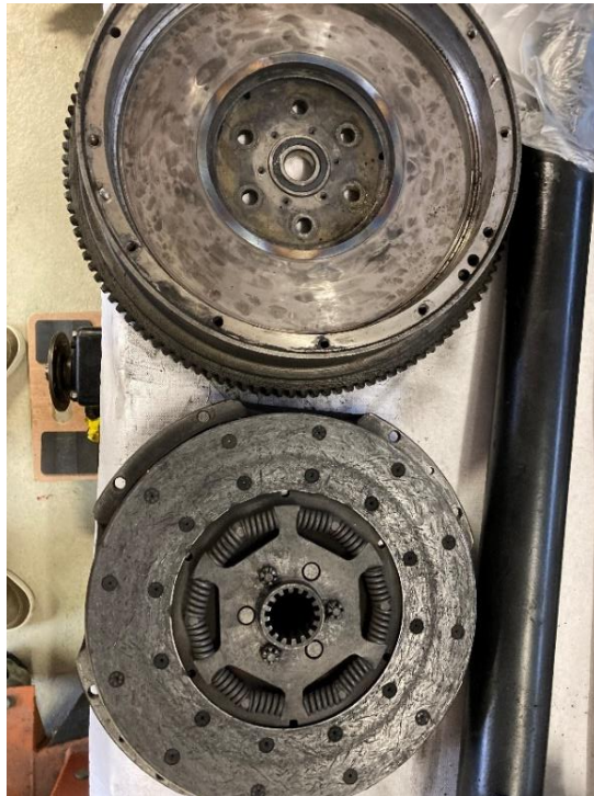
Kupplungsscheibe neu belegt, Druckplatte und Schwungrad plan geschliffen.
