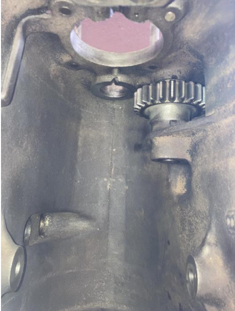
Blick ins leere Getriebegehäuse. Nur das Zahnrad für den Rückwärtsgang ist nicht demontiert.
